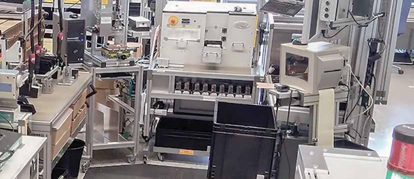
же линии обязательно одновременно производятся несколько устройств из одного семейства. Поскольку они отличаются по конструкции, длительность операций сборки также оказывается различной. «Самая сложная задача — балансировка технологической линии, — поясняет Бастиан. — Требуется точно скоординировать ручные и автоматизированные процессы так, чтобы различные устройства изготавливались на одной и той же линии без задержек».
